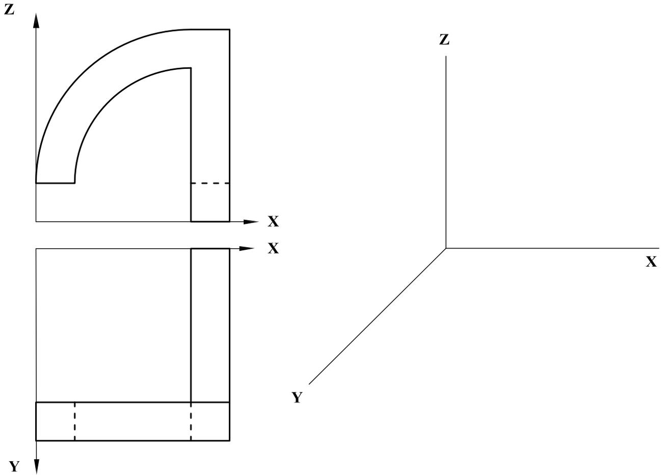
**B4.-** Representar en diédrico, incluyendo los cortes que se consideren necesarios, la planta y el alzado de la pieza dada como dibujo isométrico (sin coeficientes de reducción). Acotar la pieza para su correcta definición dimensional.
