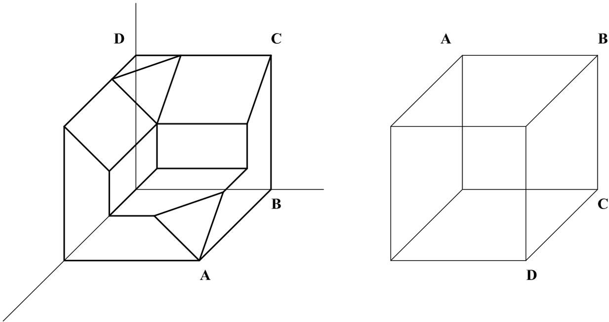
**A4.-** Completar la representación de la pieza añadiendo la vista lateral derecha. Acotar la pieza para su correcta definición dimensional.
